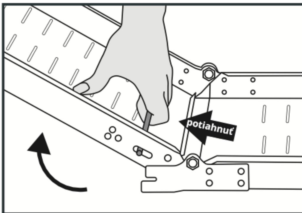
Na sklopenie pritlačte tyč na spodnej strane proti sile pruženia drážok a rampu zároveň poskladajte.
