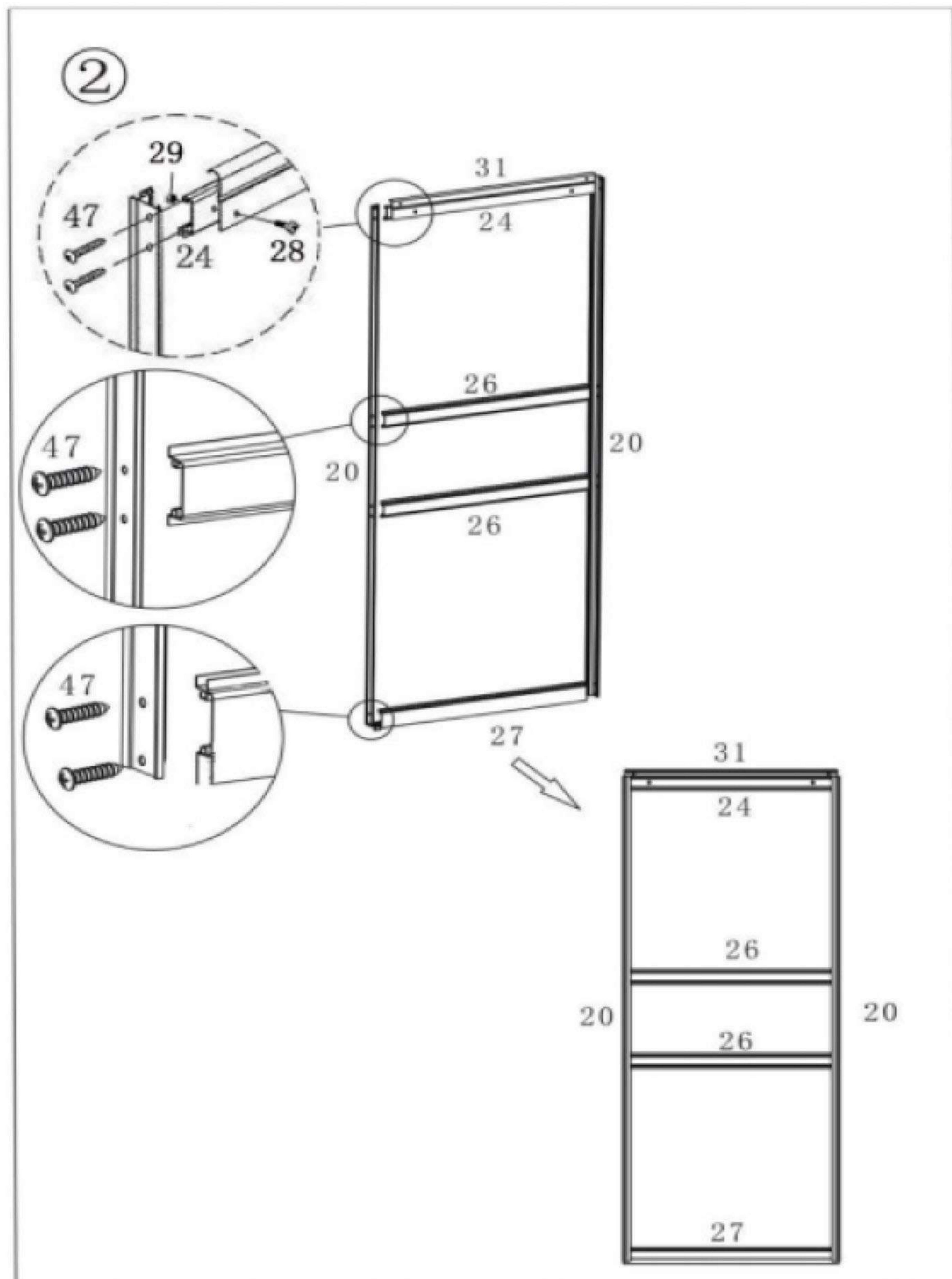
Zmontujte dvere a odložte ich nabok na neskoršie použitie. Dbajte na to, že v tomto kroku nesmiete ešte nasadiť plexisklové tabule.
