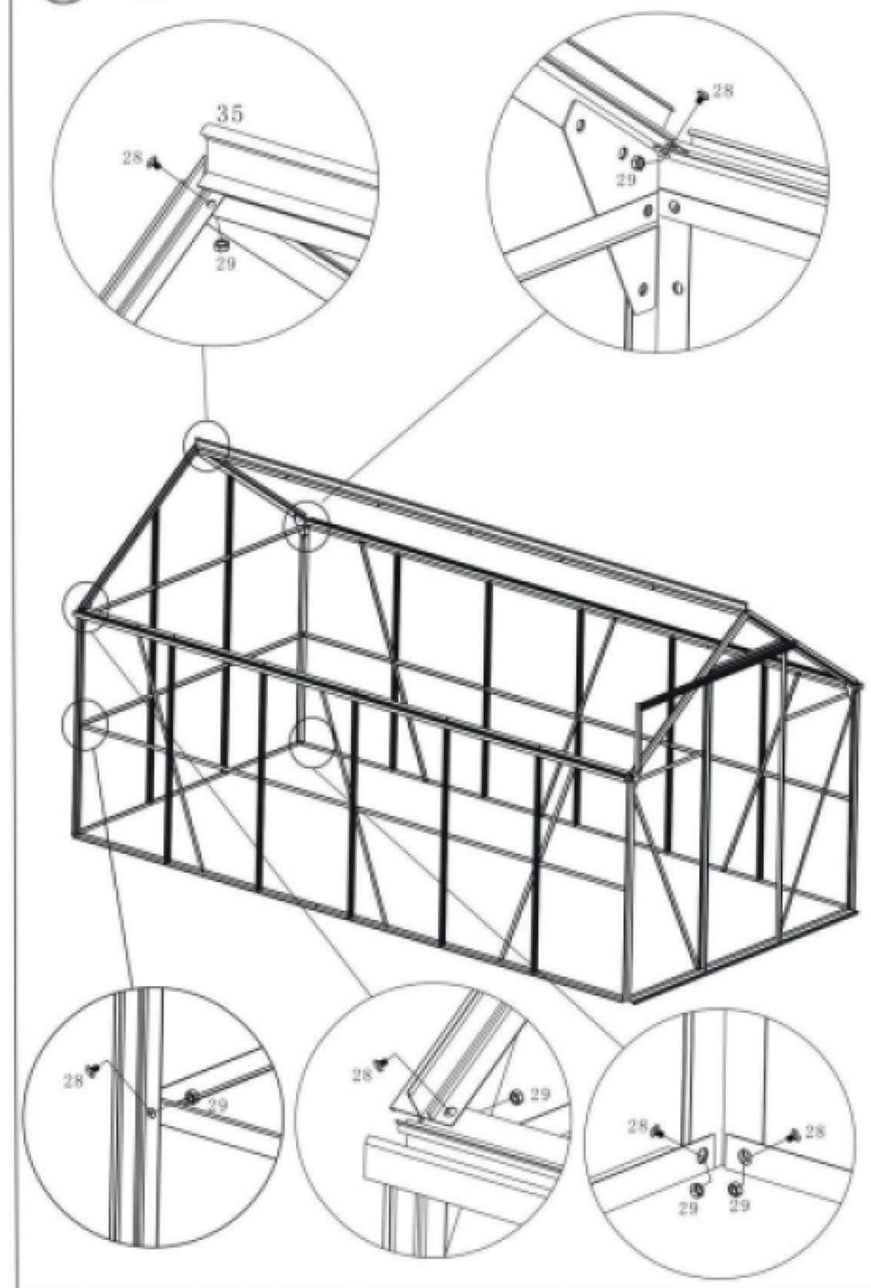
Pri montáži bočných dielov začať so zadnou stenou, a túto, pokiaľ je to možné, nastaviť kolmo. Ak to nie je možné, mali by ste požiadala o pomoc ďalšie 1-2 osoby. Pri montáži strešnej časti by ste si mali zobrať aj rebrík. Dajte pozor na jeho bezpečné postavenie a stojte na ňom vždy oboma nohami.
