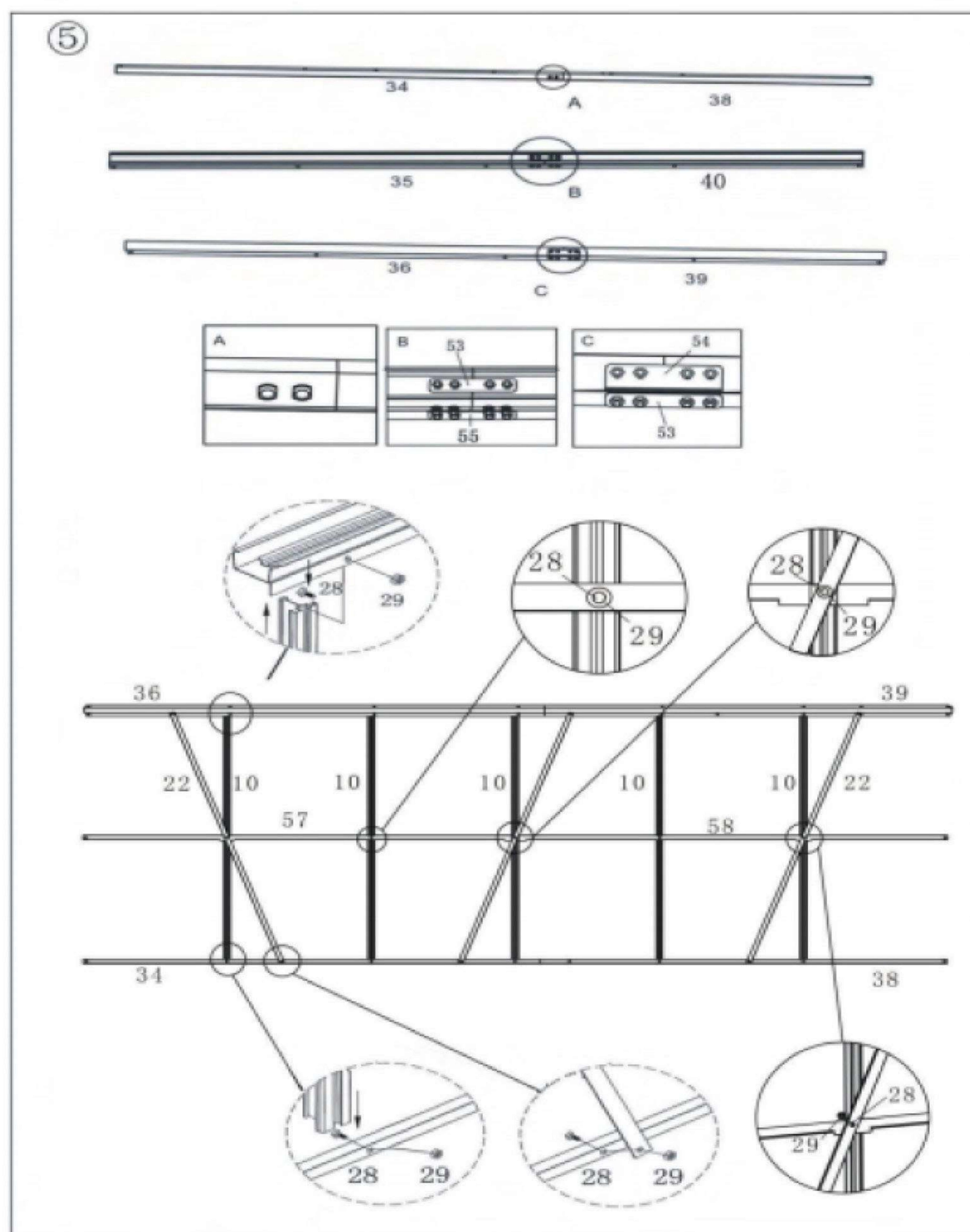
**Upozornenie:** Nedotahujte šrauby počas montáže napevno, aby v priebehu montáže bolo možné ešte prispôsobovanie. Priame pevné dotiahnutie skrutiek by mohlo spôsobiť, že skleník sa nebude dať postaviť, lebo diely na seba nebudú pasovať.
