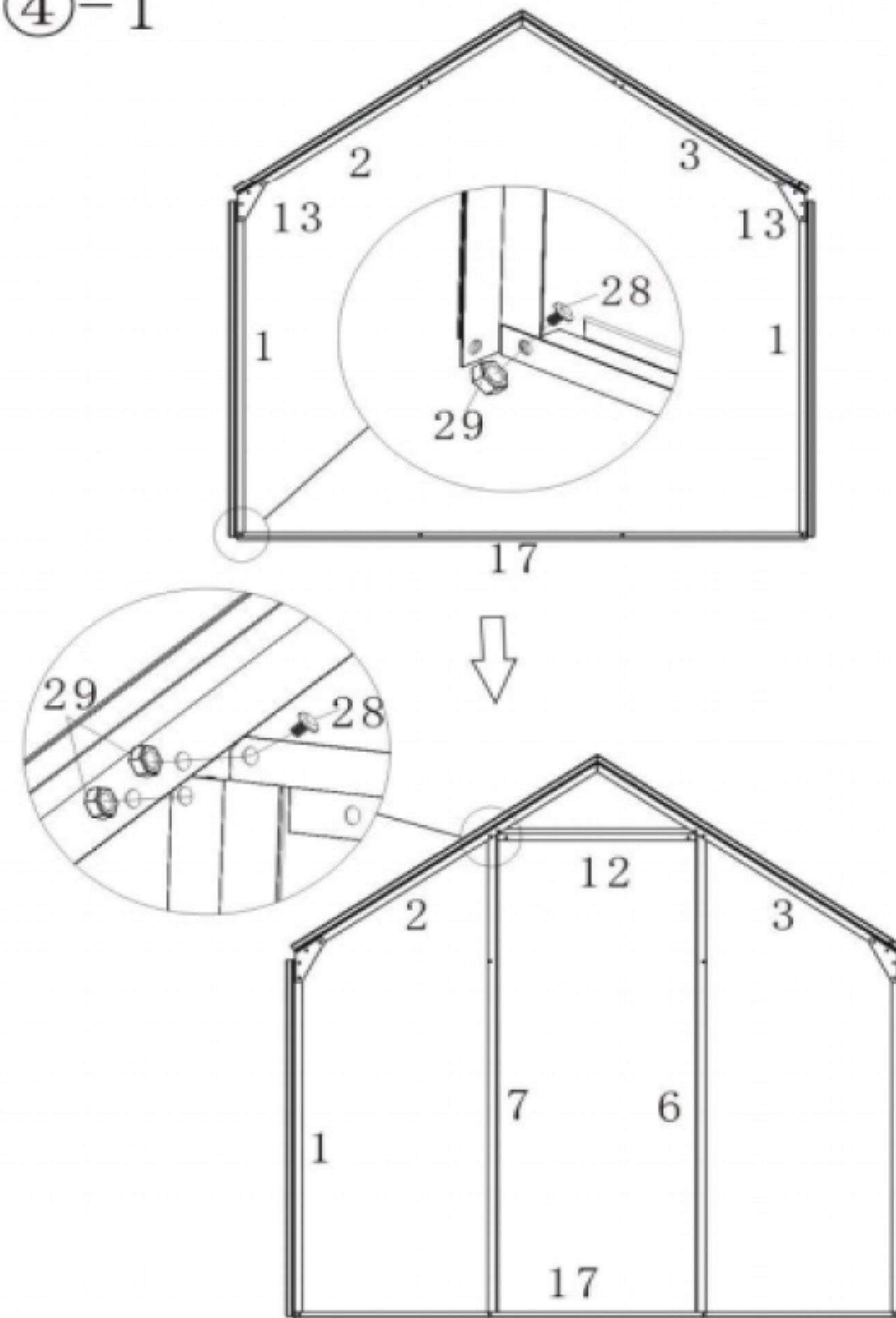
Zmontujte prednú stenu odložte ju nabok na neskoršie použitie. Dbajte na to, že v tomto kroku nemusíte ešte nasadiť plexisklové tabule. Pre čo najjednoduchšiu montáž začnite s dielom 17.
