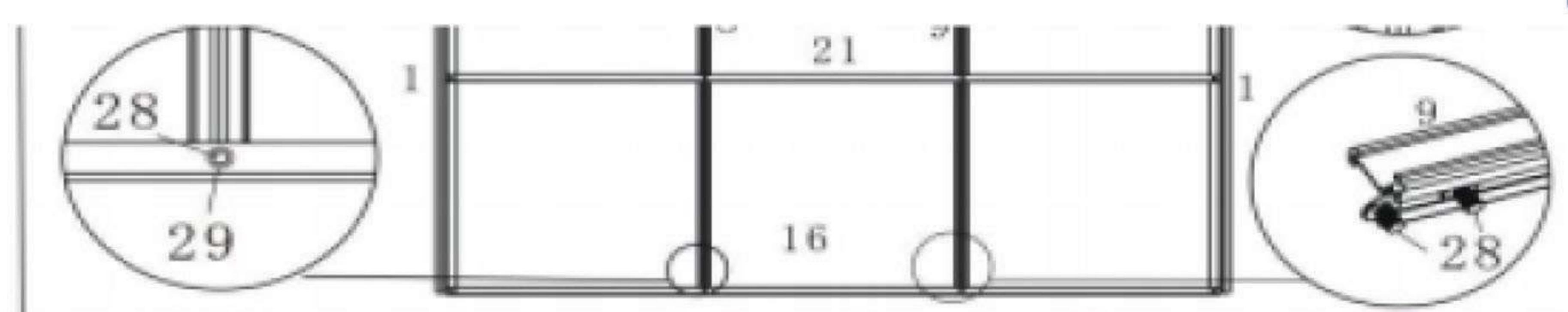
Zmontujte zadnú stenu a odložte ju nabok na neskoršie použitie. Dbajte na to, že v tomto kroku nesmiete ešte nasadiť plexisklové tabule. Pri montáži zasuňte skrutky s hlavou skrutky do profilu (viď horný obrázok) a posuňte ich na rôzne potrebné pozície. Tento postup sa bude pravidelne opakovať.
